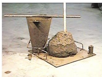
Consistenza S3 slump 100 - 150 mm
