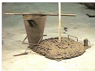
Consistenza S5 slump > 220 mm
