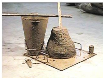
Consistenza S2 slump 50 - 90 mm
