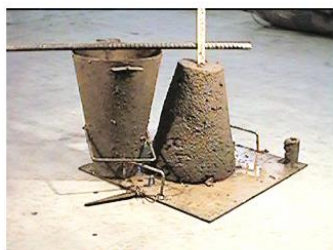
Consistenza S1 slump 10 - 40 mm
