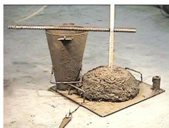
Consistenza S4 slump 160 - 210 mm
